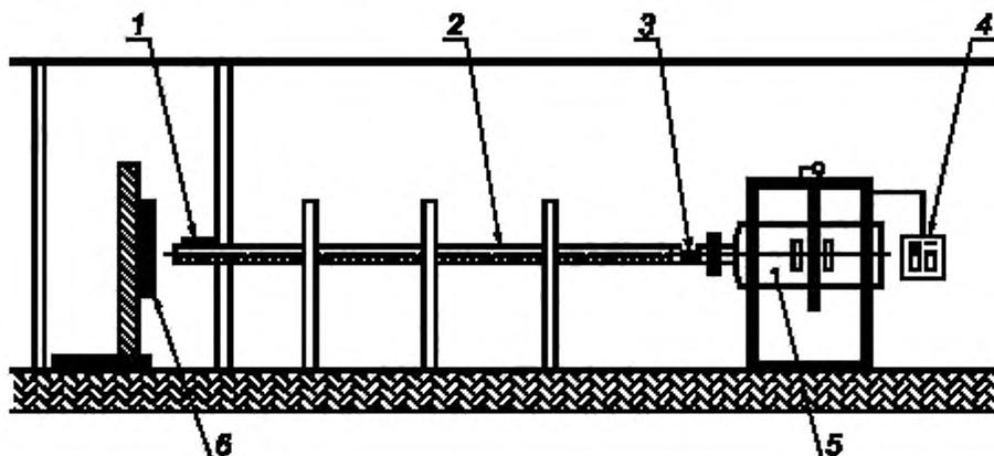
1 — измеритель скорости; 2 — ствол; 3 — перемещаемый «снаряд»; 4 — пульт управления; 5 — баллон сжатого воздуха;
