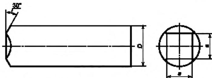
Закалить до 56<sup>±4</sup> HRC с минимальной глубиной закалки 0,5 мм.
