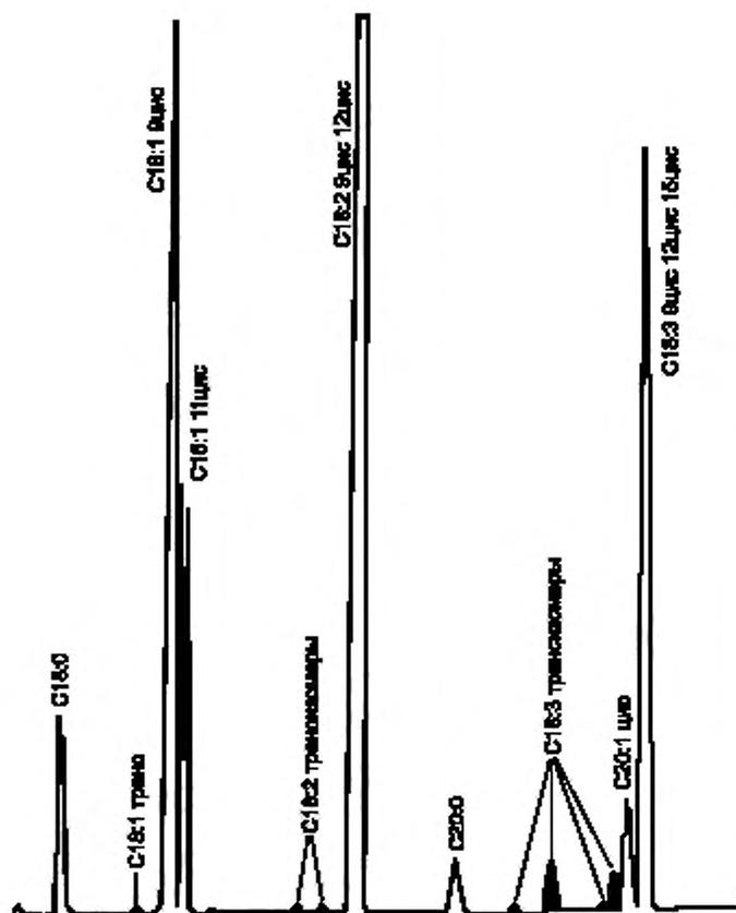
Примечание — Получено на колонке типа SP<sup>TM</sup>-Sil 88 50 м × 0,25 мм × 0,20 мкм (Chrompack) при температуре 175 °С (изотерма). Пики трансизомеров жирных кислот затенены.
