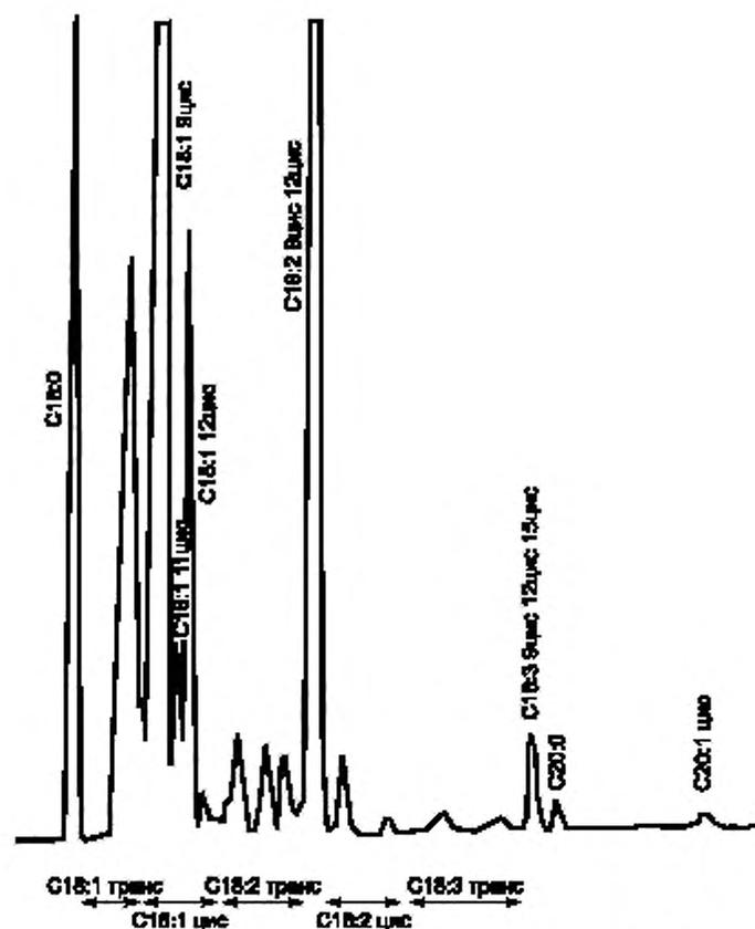
Примечание — Получено на колонке типа ВРХ-70 (SGE) 50 м × 0,22 мм × 0,25 мкм при температуре 198 °С (изотерма). На хроматограмме показаны области цис- и транс-изомеров жирных кислот.
