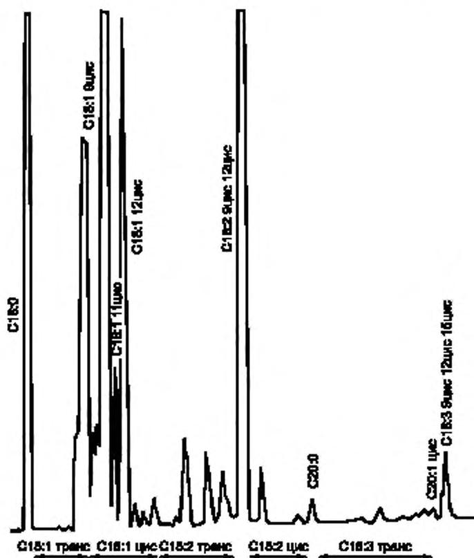
П р и м е ч а н и е — Получено на колонке типа CP™-Sil 88 (Chrompack) 50 м × 0,25 мм × 0,20 мкм при температуре 175 °С (изотерма). На хроматограмме показаны области цис- и транс-изомеров жирных кислот.
