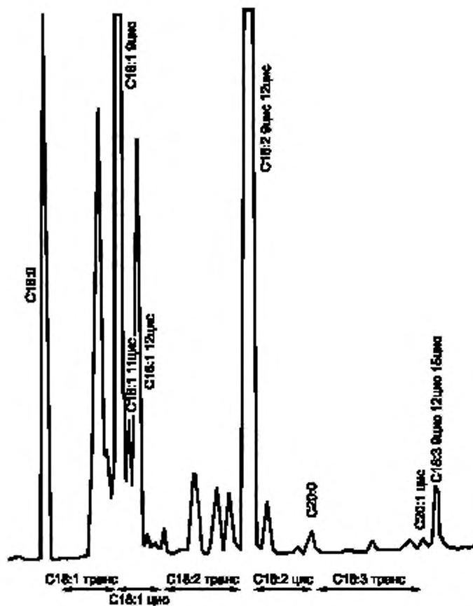
Примечание — Получено на колонке типа SP-2340 (Supelco) 60 м × 0,25 мм × 0,20 мкм при температуре 190 °С (изотерма). На хроматограмме показаны области цис- и транс-изомеров жирных кислот.
