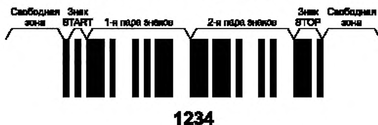
Рисунок 3 — Символ Interleaved 2 of 5, включая свободные зоны
