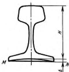
$\Delta$  — предельное отклонение вогнутости подошвы, мм;  $MN$  — линии прилегающей плоскости
