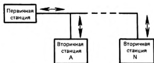
Рисунок 1 — Конфигурация несбалансированного звена данных
