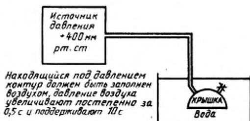
Рисунок 106 — Испытание герметичности диафрагмы (см. 17.101.2)
