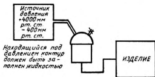
Рисунок 107 — Испытание давления, наращиваемого постепенно (см. 45.101)
