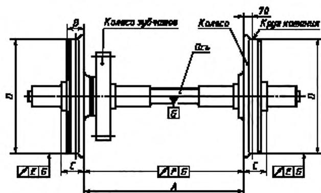
*A* — расстояние между внутренними торцами (гранями) ободьев колес; *B* — ширина обода колеса; *C* — расстояние между упорным торцом предподступичной части оси и внутренним торцом обода колеса; *D* — диаметр колес по кругу катания; *E* — допуск радиального биения круга катания колеса; *F* — допуск торцевого биения внутреннего торца обода колеса; *G* — геометрическая ось колесной пары
