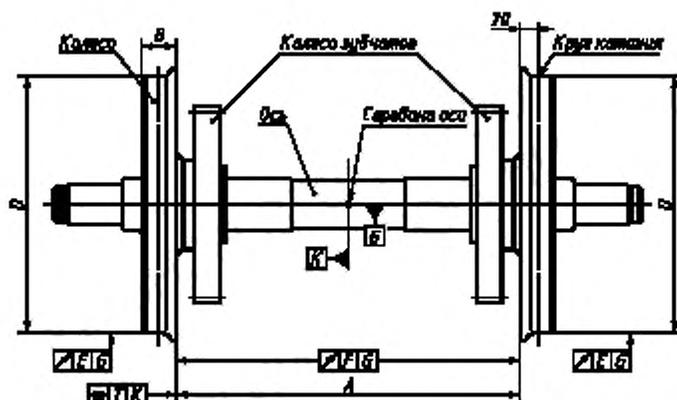
*A* — расстояние между внутренними торцами (гранями) ободьев колес; *B* — ширина обода колеса; *D* — диаметр колес по кругу катания; *E* — допуск радиального биения круга катания колеса; *F* — допуск торцевого биения внутреннего торца обода колеса; *G* — геометрическая ось колесной пары; *K* — плоскость симметрии оси; *T* — допуск симметричности размера *A*
