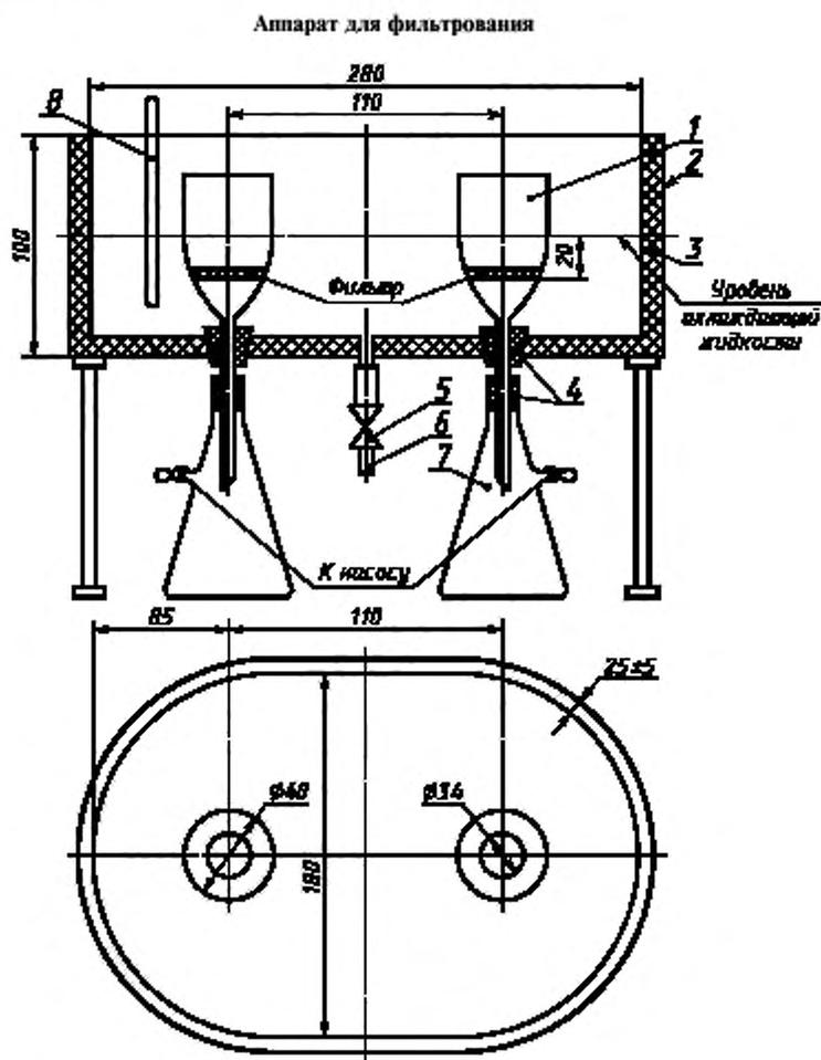
1 — фильтрующая поронка; 2 — металлическая баня, 3 — изолирующий материал (стекловата, пенопласт); 4 — резиновая пробка; 5 — зажим винтовой; 6 — резиновая трубка; 7 — колба с тубусом; 8 — термометр типа ТН-6
