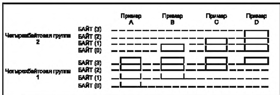
Рисунок 2.6 — Четыре способа размещения в памяти 32 разрядов данных
