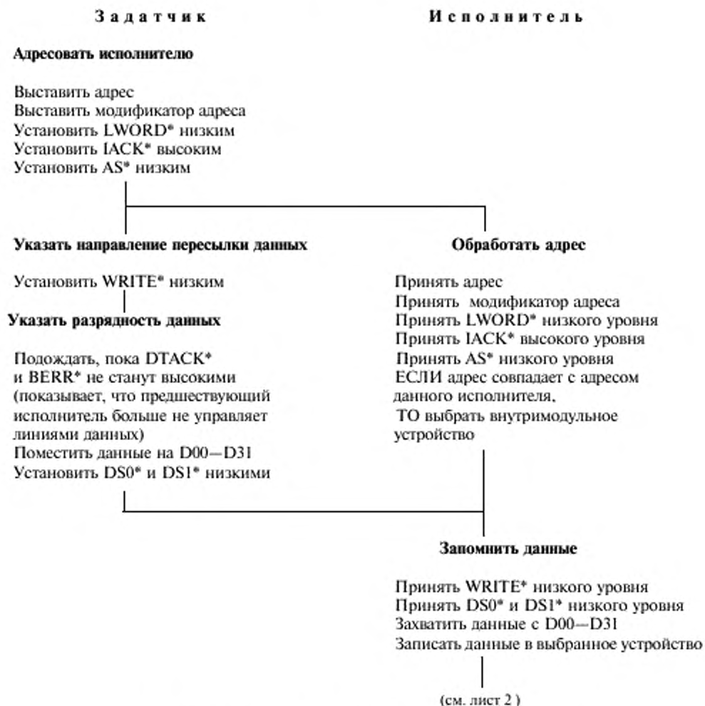
Рисунок 2.10, лист 1— Пример четырехбайтового цикла записи
