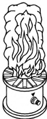
Рисунок В.2 — Расположение березовых брусков при проведении испытаний на чувствительность к тестовому очагу пожара ТП-2
