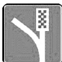
6.5 Полоса для аварийной остановки
