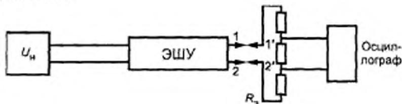
$U_n$  — источник стабилизированного напряжения;  $R_n$  — делитель
