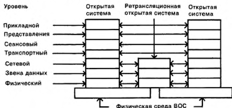
Рисунок 12 — Обмен данными через ретрансляционную открытую систему
