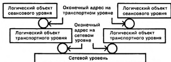
Рисунок 13 — Ассоциация адресов на транспортном уровне и адреса на сетевом уровне
