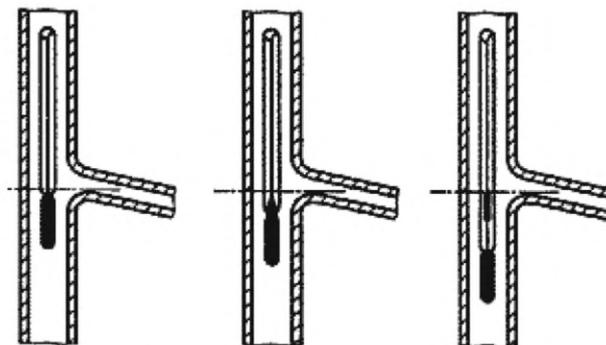
Рисунок 5 — Положение термометра в перегонной колбе
