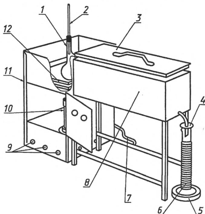
1 — колба для перегонки; 2 — термометр; 3 — крышка бани;
