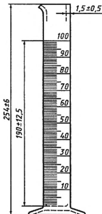
Рисунок 4 — Мерный цилиндр вместимостью 100 см<sup>3</sup>, с ценой деления 1 см<sup>3</sup>, допуск ± 1,0 см<sup>3</sup>
