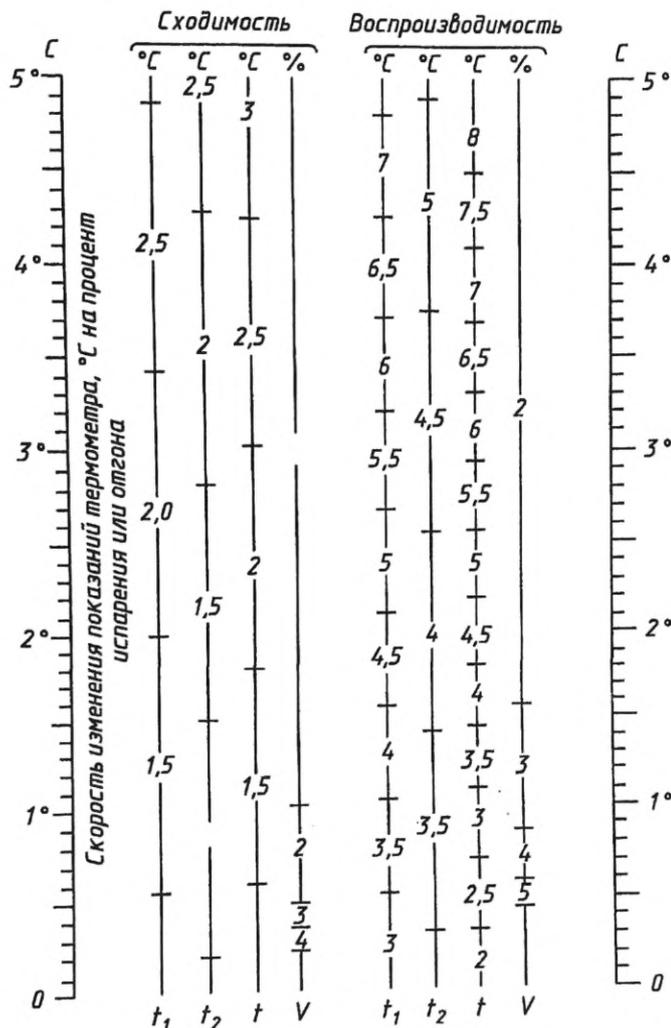
$t_1$  — температура начала кипения, °С;  $t_2$  — температура конца кипения или температура полного выкипания нефтепродукта, °С;  $t$  — температура при заданном проценте испарения или отгона, °С;
