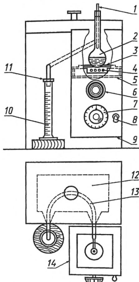
1 — термометр; 2 — колба для перегонки;
