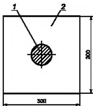
1 — цилиндрический индентор; 2 — образец для испытания
