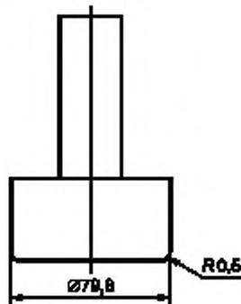
Рисунок 3 — Цилиндрический индентор
