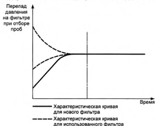
Рисунок 7 — Зависимость перепада давления на коалесцирующих фильтрах от времени
