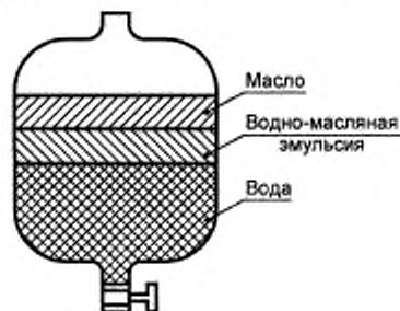
Рисунок 8 — Сепаратор для разделения масла и воды
