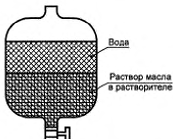
Рисунок 9 — Сепаратор для извлечения масла растворителем
