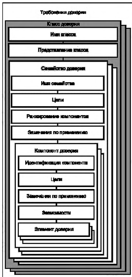
Рисунок 1 — Иерархическая структура представления требований доверия: класс-семейство-компонент-элемент
