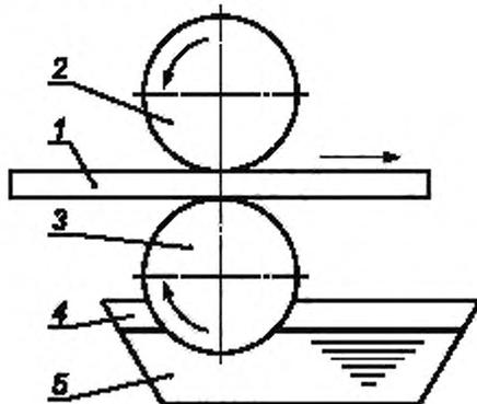
1 — плоская деталь (например, печатная плата), 2 — прижимной валик, 3 — валик для нанесения припоя, 4 — соляной слой для защиты припоя в ванне, 5 — ванна с припоем
