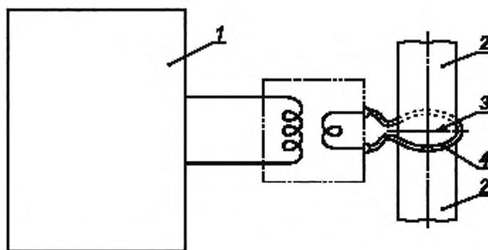
1 — генератор, 2 — деталь, 3 — соединение, 4 — индуктор
