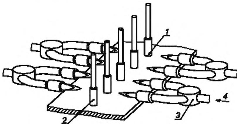
1 — припой, 2 — деталь, 3 — многопламенная горелка, 4 — горячая смесь
