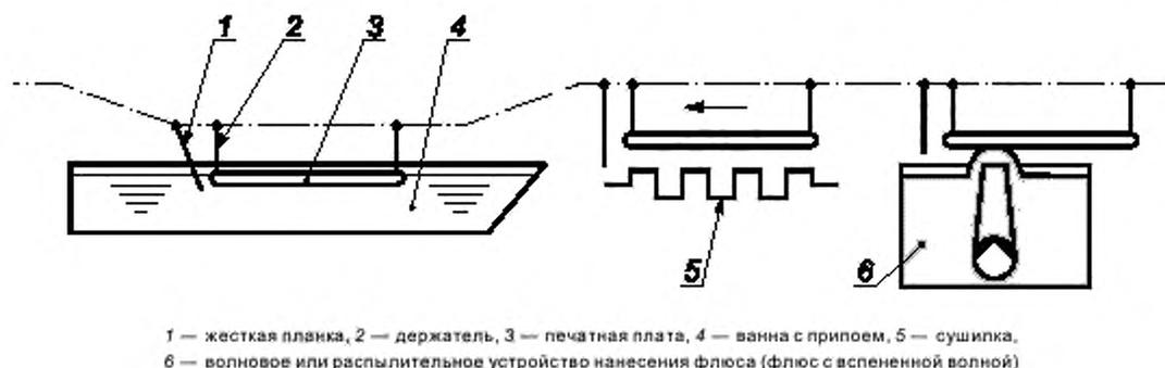
Рисунок А.5 — Низкотемпературная пайка протягиванием через расплавленный припой
