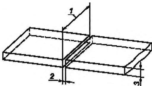
1 — длина соединения, 2 — сборочный зазор, 3 — толщина детали
