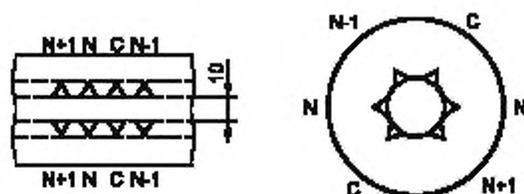
С — испытуемые образцы; N-1, N и N+1 — пирометрические контрольные конусы в ожидаемом температурном интервале испытуемого образца
