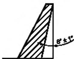
Рисунок 2 — Пирометрический контрольный конус с типичным углом наклона наружного ребра или грани
