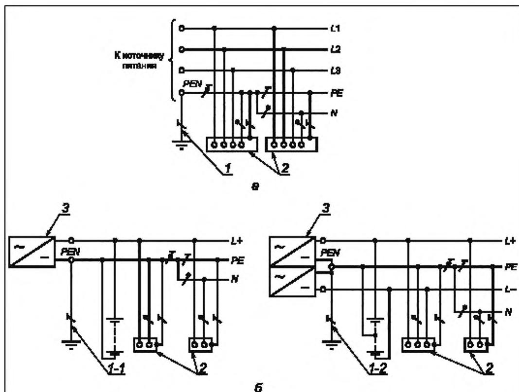
1 — заземлитель нейтрали источника переменного тока; 1-1 — заземлитель вывода источника постоянного тока;
