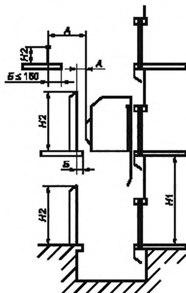
A — расстояние до движущихся элементов лифта; B — расстояние между ограждением и краем межэтажных перекрытий, ступеней и площадок; H1 — высота ограждения со стороны эстакадной площадки; H2 — высота ограждения с остальных сторон
