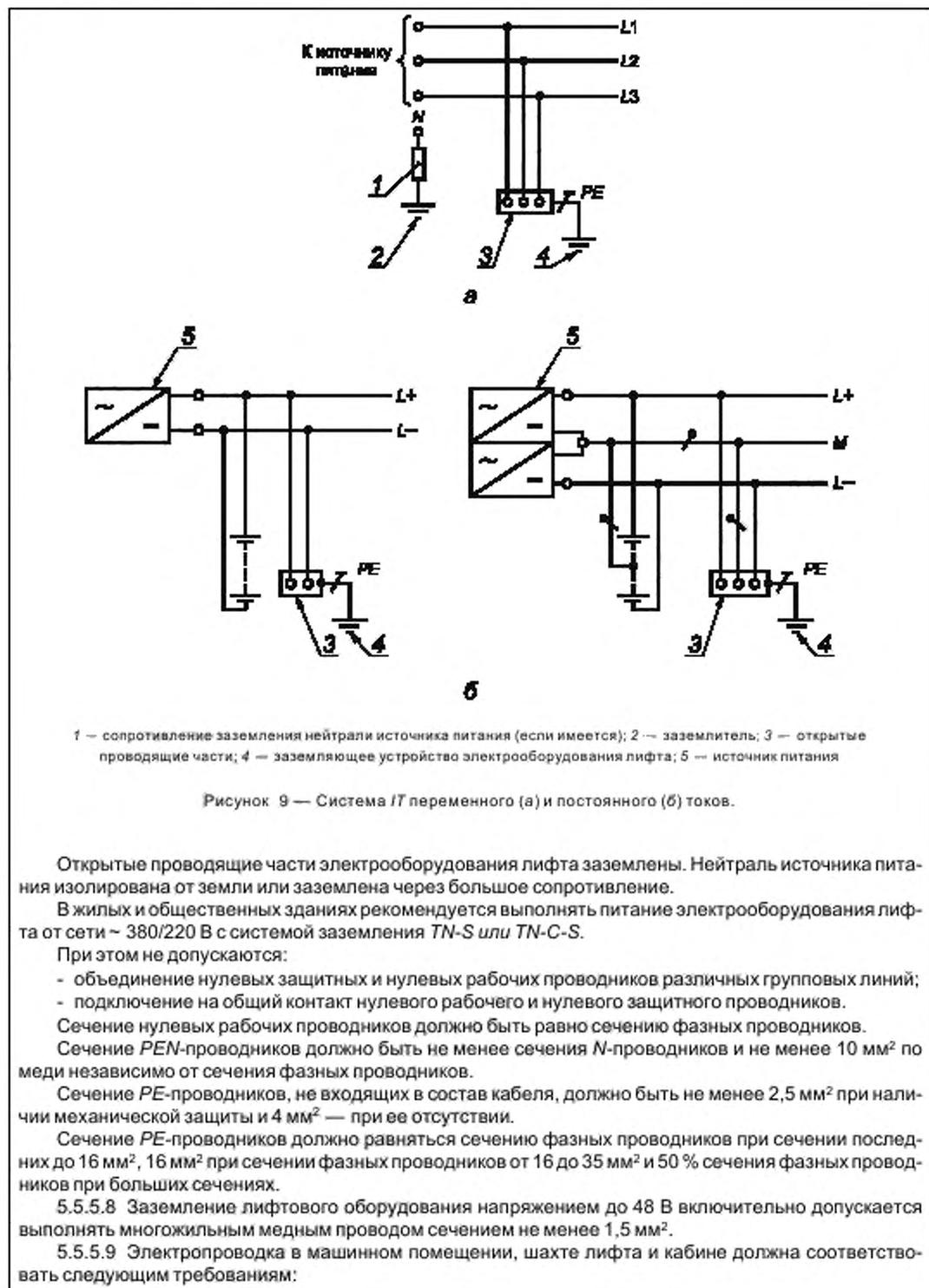
а) электропроводка должна выполняться изолированными проводами или кабелями с резиновой или равнозначной ей изоляцией;
