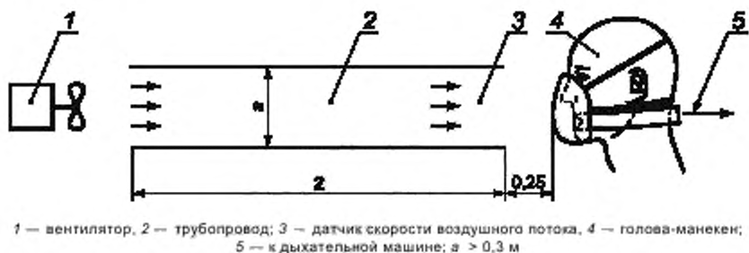
Рисунок 5 — Схема проведения испытания по определению содержания диоксида углерода во вдыхаемом воздухе
