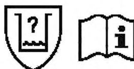
Рисунок 9 — Пиктограммы для водонепроницаемых перчаток с низким уровнем защиты от химических веществ
