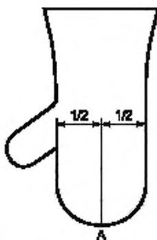
Рисунок 1 — Подвешивание перчатки для испытания
