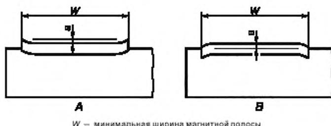
Рисунок 3 — Профиль поверхности
