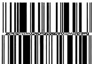
Рисунок 12 — Символ GS1 DataBar Расширенный Многострочный, представляющий номер (01)98898765432106(3202)012345(15)991231
