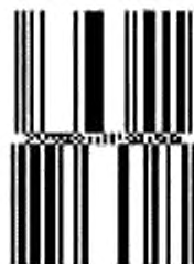
Рисунок 6 — Символ GS1 DataBar Двустрочный Всенаправленный, представляющий номер (01)00034567890125
