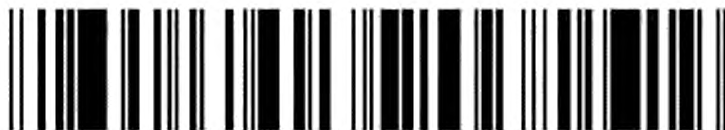
Рисунок 10 — Символ GS1 DataBar Расширенный, представляющий номер (01)98898765432106(3202)012345(15)991231
