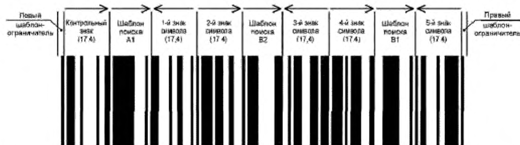
Рисунок 11 — Символ GS1 DataBar Расширенный, представляющий номер (01)90012345678908(3103)001750
