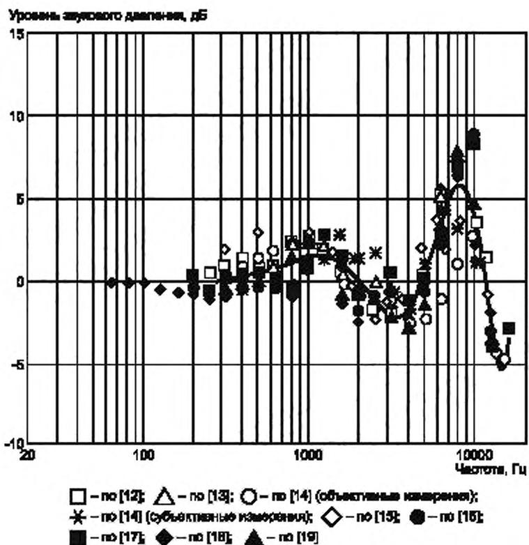
Рисунок А.2 — Экспериментальные данные для определения  $L$ , указанного в таблице 1, и расчетная кривая, обеспечивающая наилучшее сглаживание экспериментальных данных
