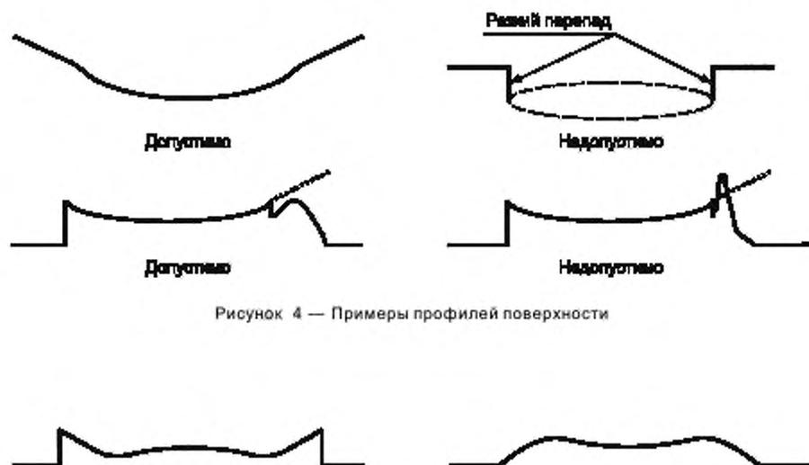
Рисунок 4 — Примеры профилей поверхности
