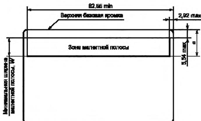
При использовании дорожек 1 и 2:  $a = 11,89 \text{ мм min}$
