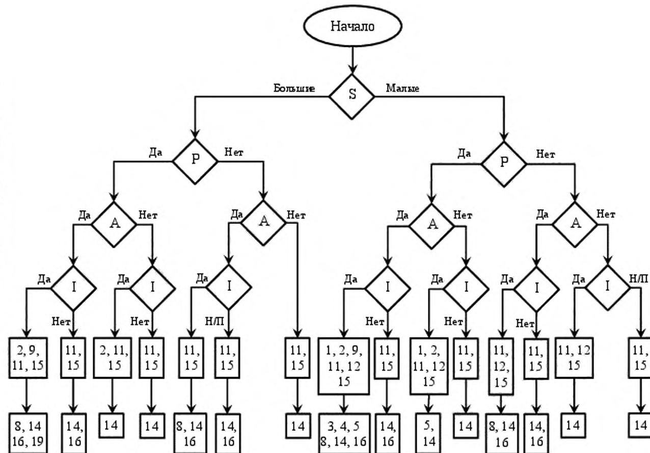
Рисунок А.3 – Дерево решений для выбора метода испытаний на герметичность
