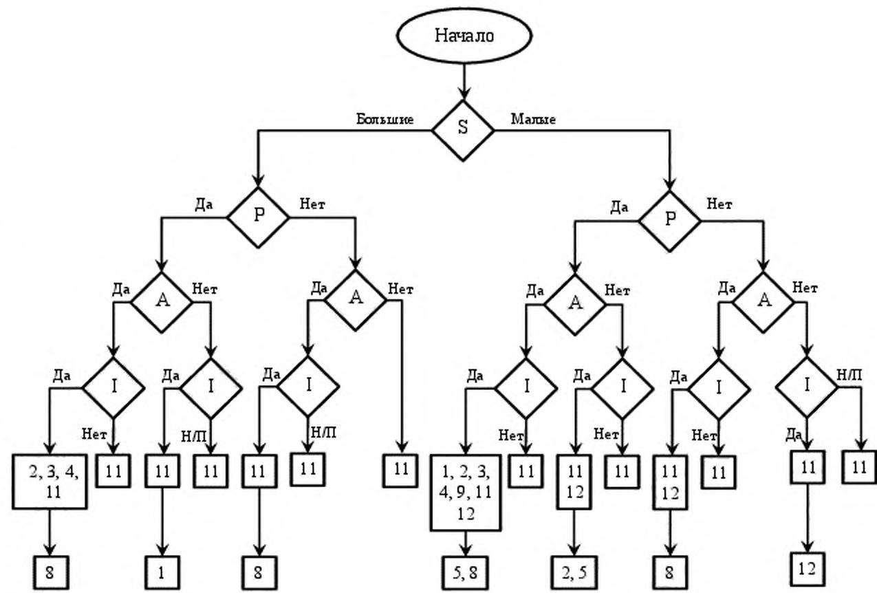
Рисунок А.1 – Дерево решений для выбора метода испытаний на герметичность
