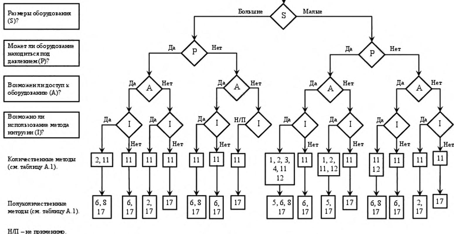
Рисунок А.2 – Дерево решений для выбора метода испытаний на герметичность
