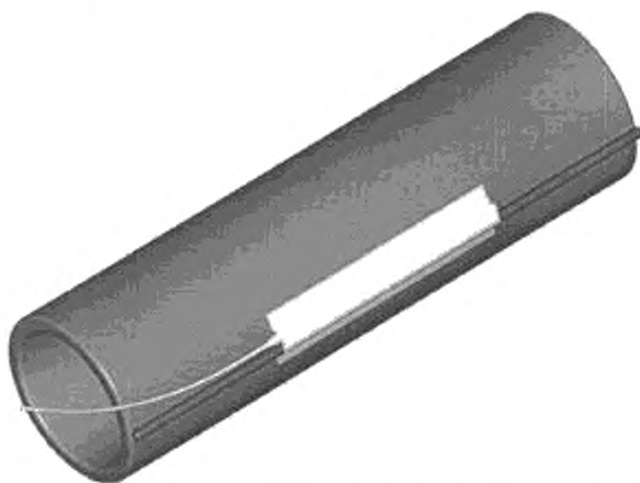
Рисунок 8 — Датчик ограничителя температуры на поверхности электроннагревателя
