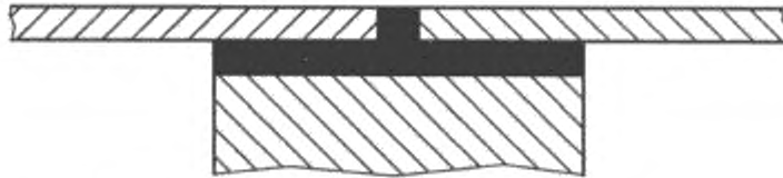
Рисунок В.3.2 – Соединение поверхностей сваркой встык с применением накладки в пищевой зоне
