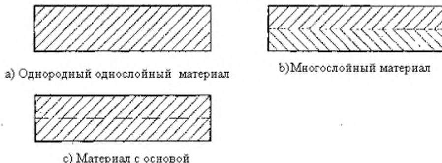
Рисунок 1 – Структура полотна материала
