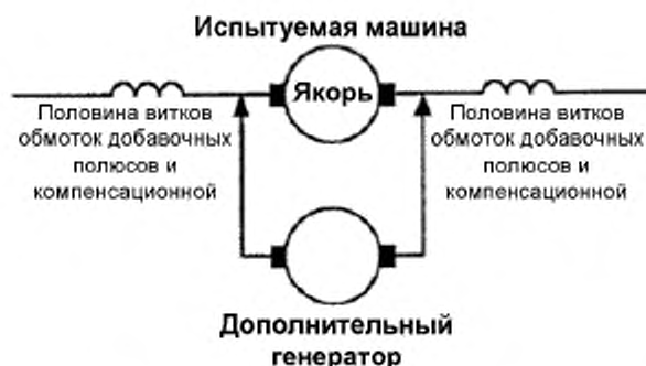
Рисунок 4 – Дополнительный генератор, используемый для увеличения или отведения части тока якоря
