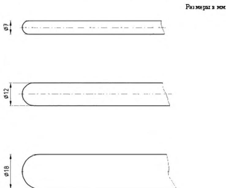
Рисунок 1 — испытательный палец
