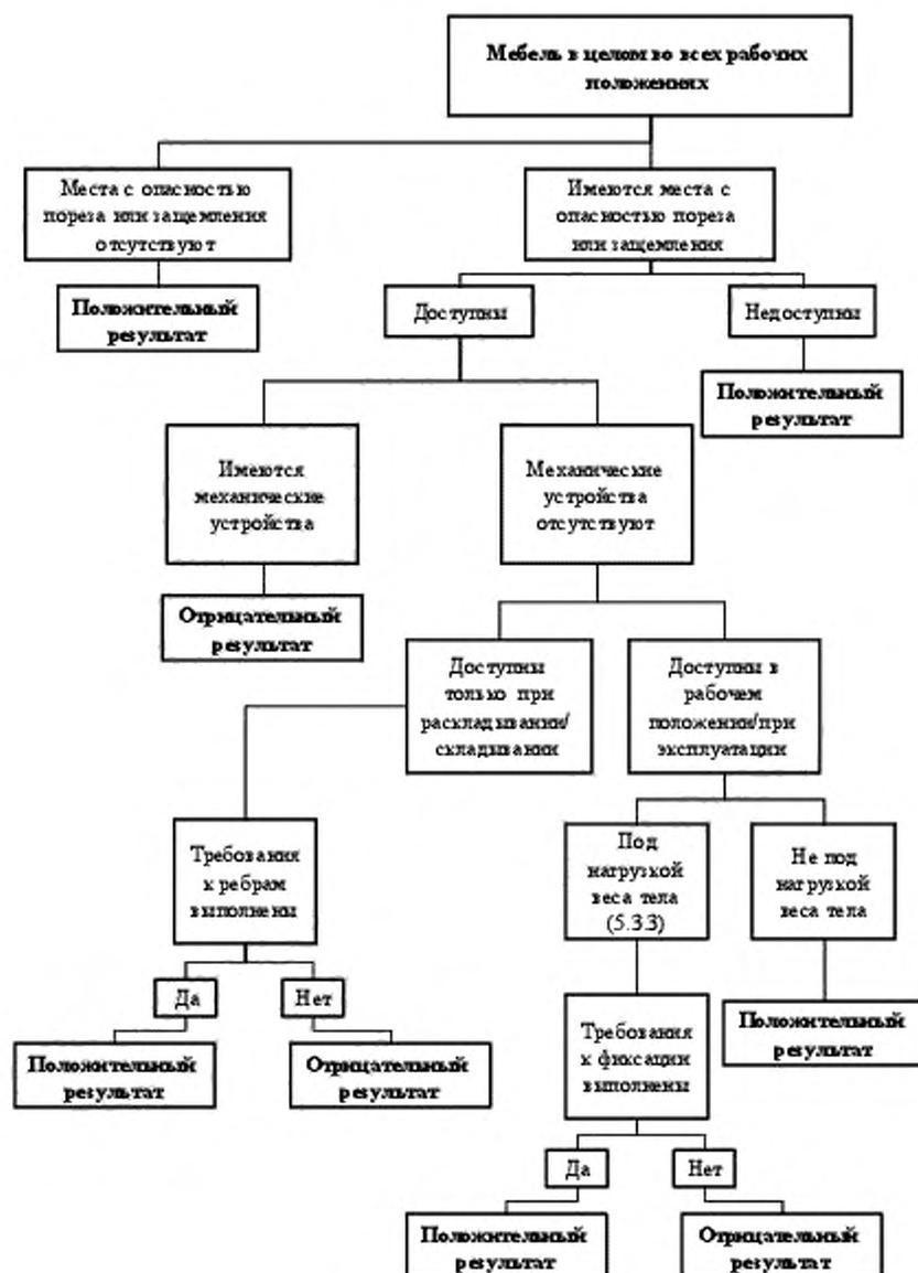
Рисунок А.1 – Схематическое представление требований к местам, представляющим опасность пореза или защемления
