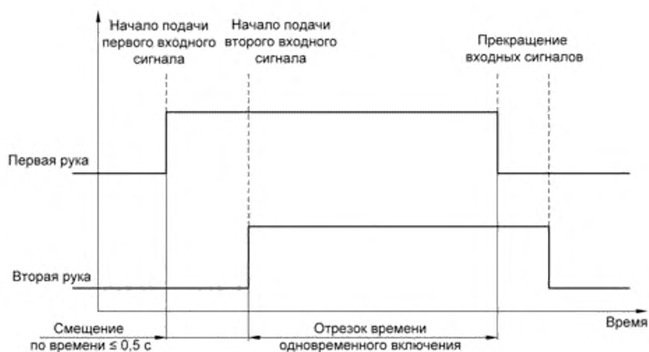
Рисунок 3 – Входные сигналы при синхронном включении
