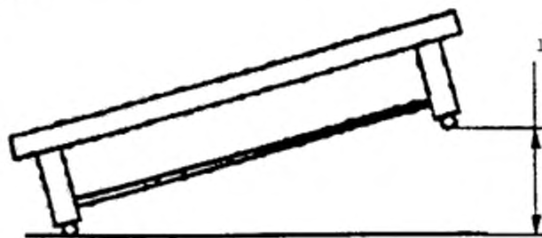
Рисунок 8 – Испытание на прочность при падении
