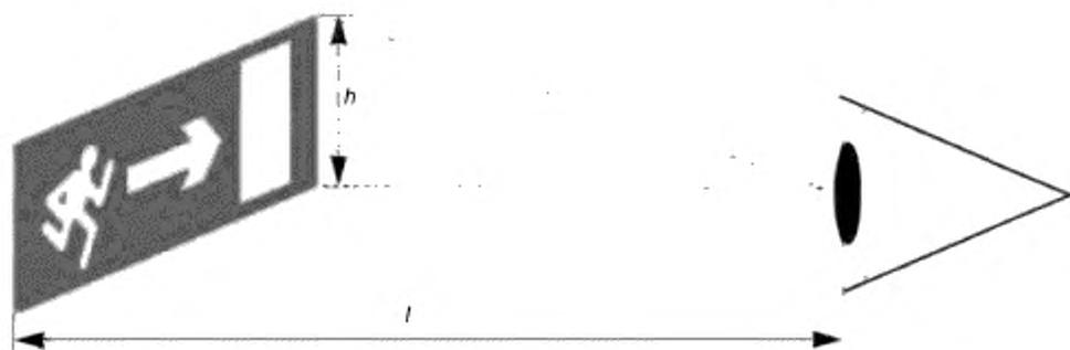
Рисунок 2 — Определение расстояния различения эвакуационного знака безопасности
