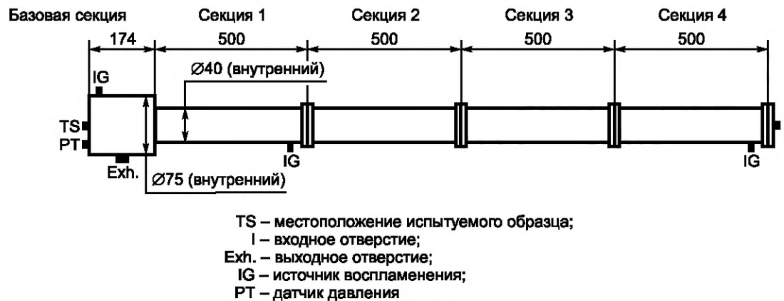
Рисунок 21 — Установка для испытаний дыхательных и дренажных устройств
