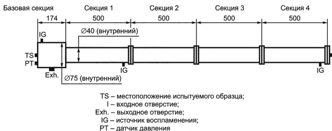
Рисунок 21 — Установка для испытаний дыхательных и дренажных устройств
