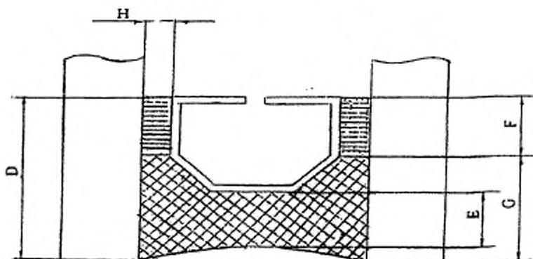
*D* – общая глубина герметизирующего слоя; *F* – глубина внутреннего (первого) герметизирующего слоя; *G* – глубина второго герметизирующего слоя; *E* – глубина наружного герметизирующего слоя; *H* – толщина первого герметизирующего слоя
