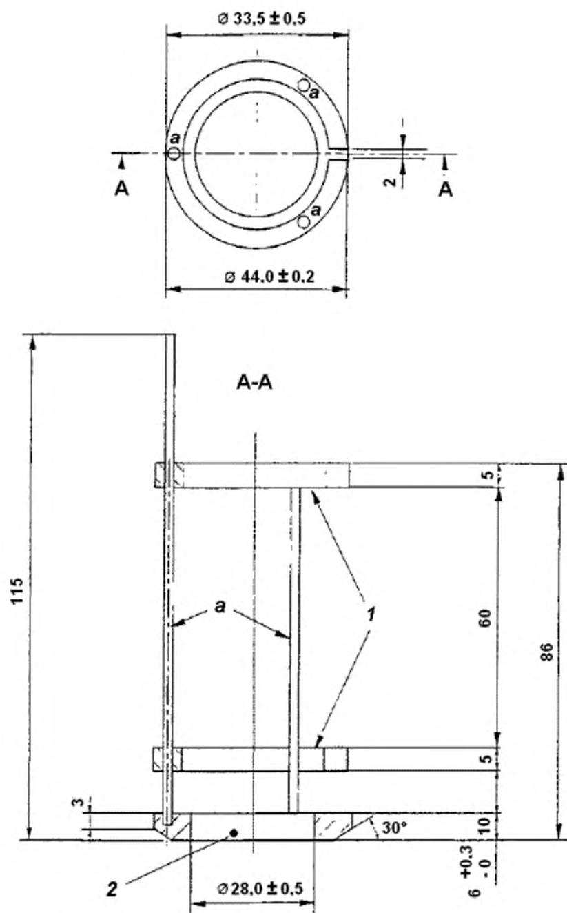
a – проволока из нержавеющей стали диаметром 2 мм;
