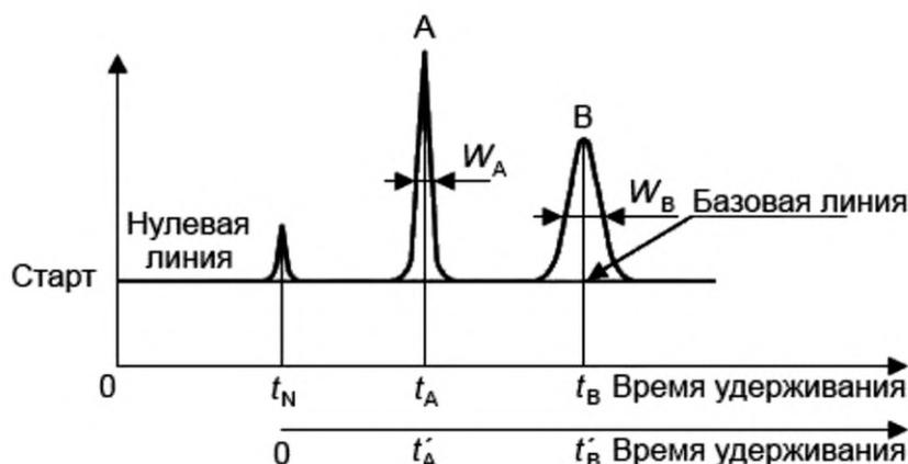
Рисунок 1 — Вычисление разрешения между пиками A и B
