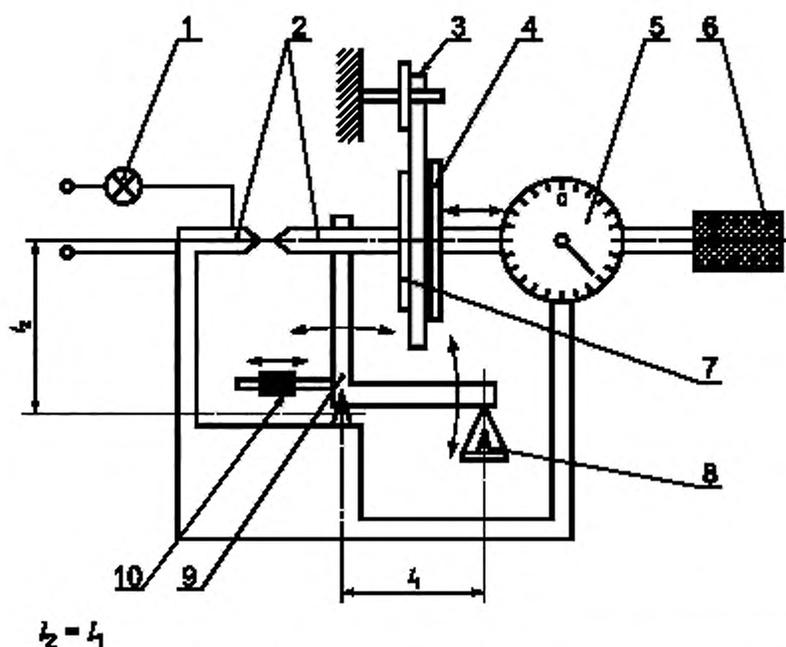
1 — лампочка; 2 — контакты; 3 — проба; 4 — нажимная пластина; 5 — измерительное устройство с крупной шкалой;
