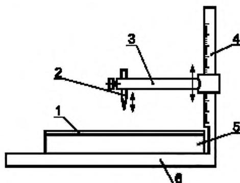
1 — измерительная пластина; 2 — вертикальный щуп; 3 — измерительный стержень; 4 — вертикальная линейка;
