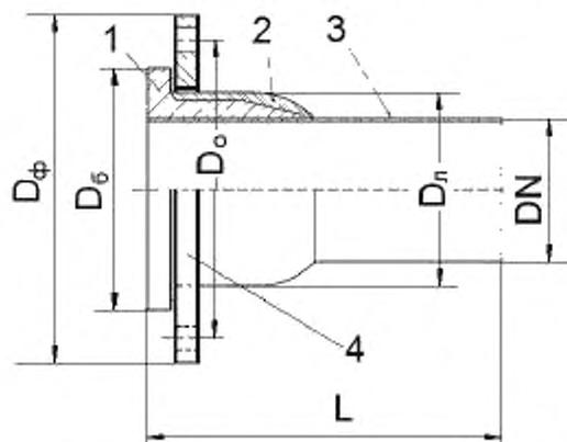
1 – формованный упорный буртик; 2 – ламинирование буртика и патрубка;
