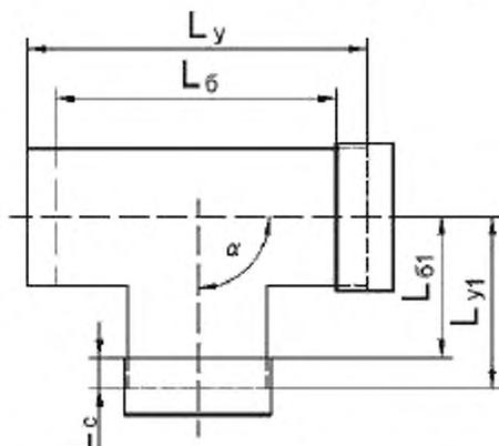
$L_y$  – уложенная длина тройника по главной трубе;  $L_б$  – базовая длина главной трубы;  $L_{y1}$  – уложенная длина бокового патрубка;  $L_{б1}$  – базовая длина бокового патрубка;  $\alpha$  – установочный угол тройника
