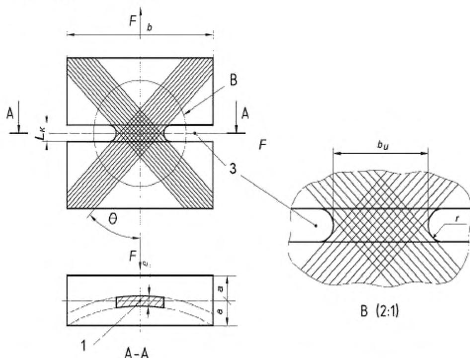
$b$  – ширина образца; 3 – область надреза;  $L_x$  – расстояние между зажимами;  $b_u$  – ширина образца в месте сужения (надреза);
