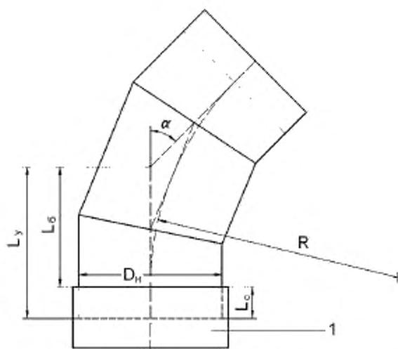
1 – муфта;  $D_n$  – наружный диаметр трубы;  $L_y$  – уложенная длина отвода;  $L_b$  – базовая длина;  $L_c$  – длина соединения;  $\alpha$  – угол отвода;  $R$  – радиус отвода.
