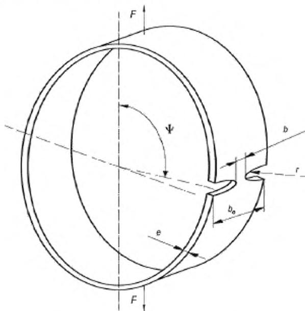
$F$  – растягивающая сила;  $e$  – толщина стенки образца;  $b_0$  – ширина образца;  $b$  – ширина образца в месте надреза;  $r$  – радиус надреза;  $\Psi$  – угол, определяющий расположение надреза относительно направления растягивающей силы
