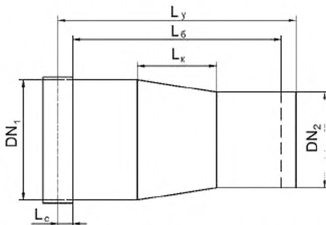
DN<sub>1</sub> – больший номинальный диаметр; DN<sub>2</sub> – меньший номинальный диаметр
