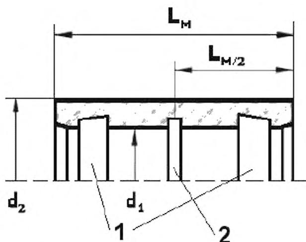
1 – канавки под кольцевые уплотнители; 2 – канавка под центральный ограничитель (упор);  $L_M$  – длина муфты;  $L_{M/2}$  – половина длины муфты;  $d_1$  – внутренний диаметр муфты;  $d_2$  – наружный диаметр муфты
