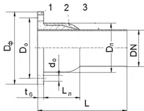
1 – формованный фланцевый буртик; 2 – ламинирование буртика и патрубка;
