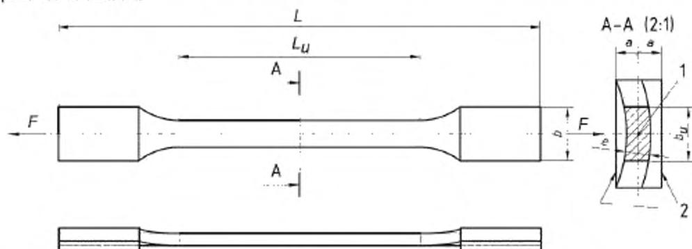
1 – центр тяжести поперечного сечения образца на измерительной базе; 2 – наращенные участки на концах образца;  $F$  – направление действия растягивающей силы;  $L$  – общая длина образца;  $L_u$  – длина измерительной базы;  $b$  – ширина образца в зажимах;  $2a$  – толщина наращенной части концов образца;  $b_u$  – ширина образца на измерительной базе;  $e$  – толщина образца (стенки трубы)
