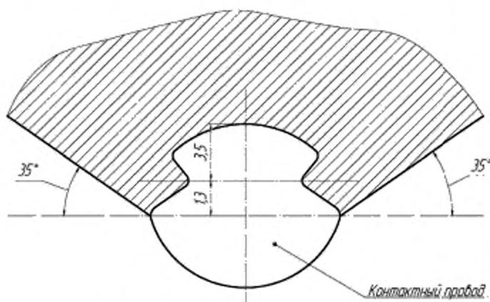
Рисунок 1 — Область расположения арматуры на контактном проводе
