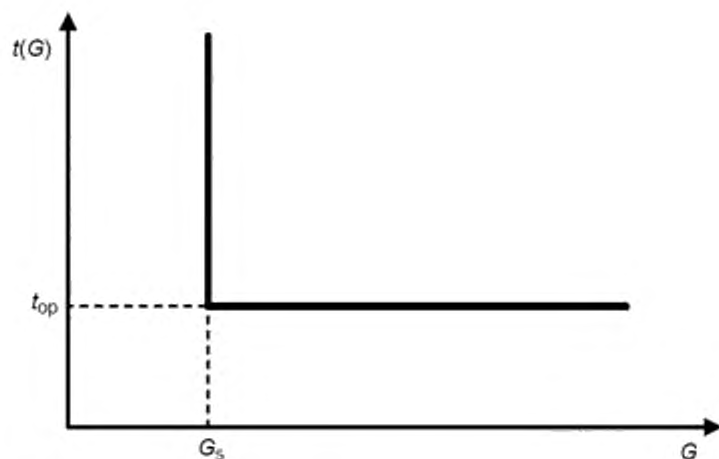
Рисунок 2 — Независимая характеристика времени реле сверхнапряжения
