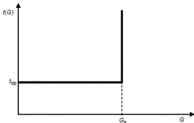
Рисунок 3 — Независимая характеристика времени реле недостаточного напряжения
