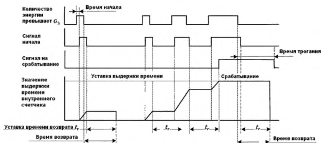
Рисунок 6 — Характеристика, поясняющая время возврата реле
