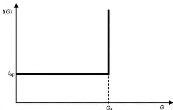
Рисунок 3 — Независимая характеристика времени реле недостаточного напряжения
