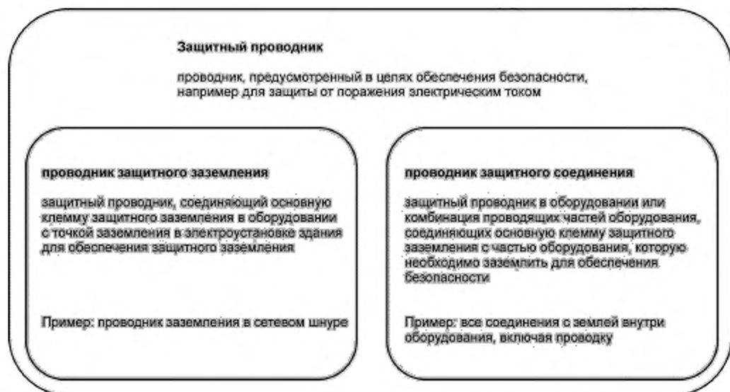
Рисунок 10 — Общие сведения о защитных проводниках
