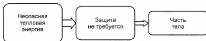
Рисунок 22 — Модель защиты в условиях отсутствия термической опасности
