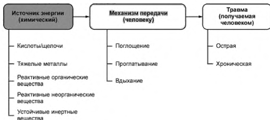
Рисунок 19 — Модель получения химических травм
