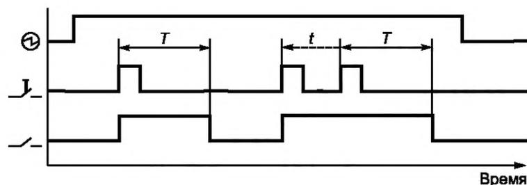
Рисунок 12 — Реле сторожевого таймера
