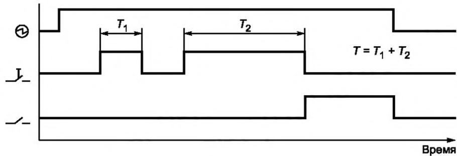
Рисунок 7 — Реле с суммированием времени
