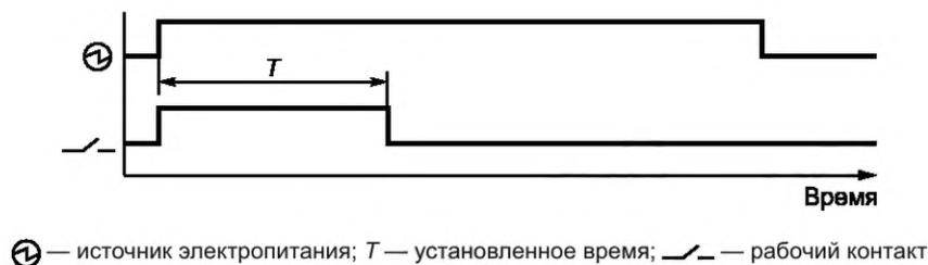
Рисунок 10 — Интервальное реле
