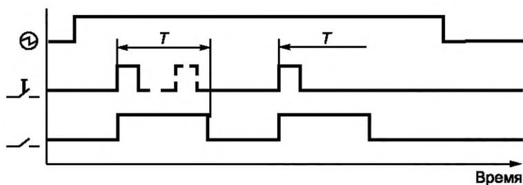
Рисунок 11 — Интервальное реле с управляющим сигналом
