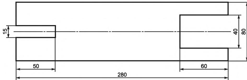
Толщина пластины 6 мм
