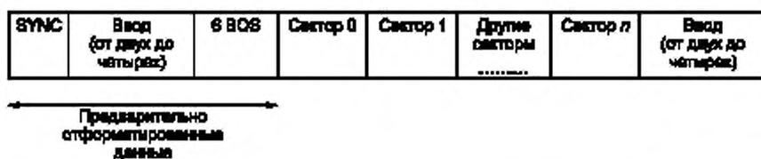
Рисунок В.5 — Структура полной дорожки, секторы типов 0—5
