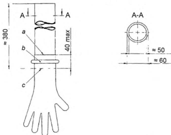
*a* – манжета перчатки; *b* – фиксирующее устройство; *c* – конец трубки для наполнения
